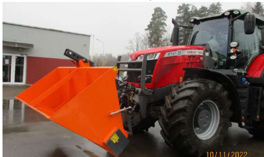
31 pav. Ant traktoriaus pakabinamas smėlio- druskos barstytuvas
